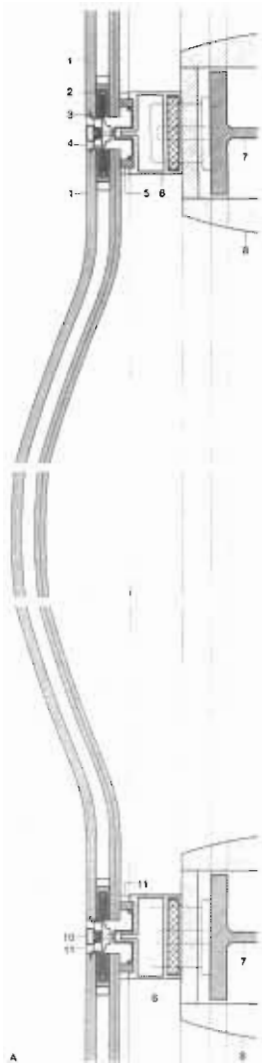
سقف و کف از نخبه سه لایه با پوشش ورقه PVC Ceiling & floor, plywood with PVC layer
